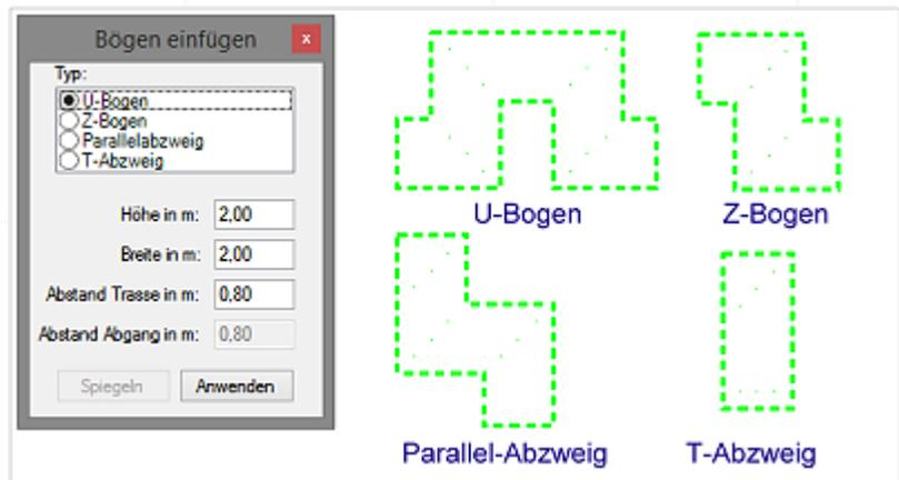
Abb. 3 Funktion „Bogen einfügen“
