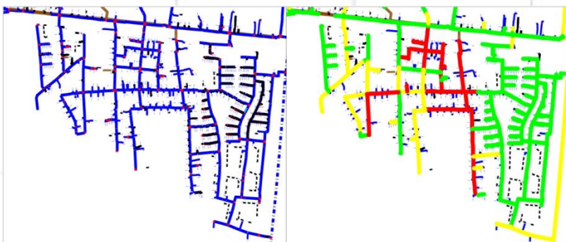
Abb. 18 Darstellung des Wassernetzes vor (li.) und nach der Rohrbruchanalyse (re.)
